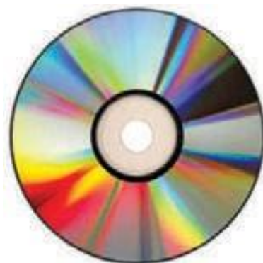
Hình 38.14: Các vạch rất mảnh, mỗi vạch có độ rộng 1\ \mu\text{m} , trên đĩa compact laser tác dụng như một cách tử nhiễu xạ
