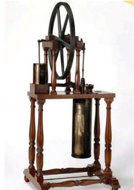
Hình 22.1: Động cơ Stirling vào đầu thế kỷ XIX
