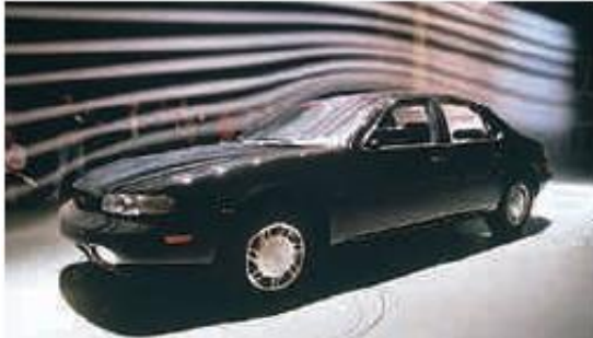
Hình 14.7: Chuyển động thành lớp của chất khí khi xe chuyển động trong hầm
